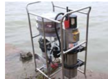
多级原位海水采集系统 (大体积泵)
