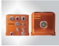
iPos MS 系列高精度惯性组合导航系统
