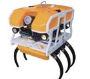
Underwater Ambush Rescue 水下环抱救援机器人
