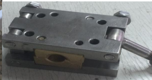
流量计与绞车连接机构
