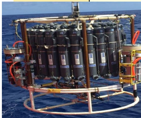
基于CTD或ROV的多层多级异步取样系统
